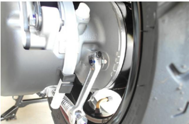
▲ 鼓式煞車示意圖。
