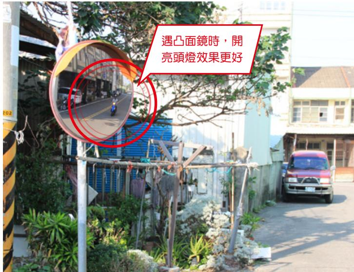
▲ 彎道凸面鏡可投射機車頭燈，提醒對向來車注意。
