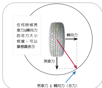
圖2B 縱向（煞車或驅動力）與橫向（轉向力）的合力不會超過摩擦圓的界限
